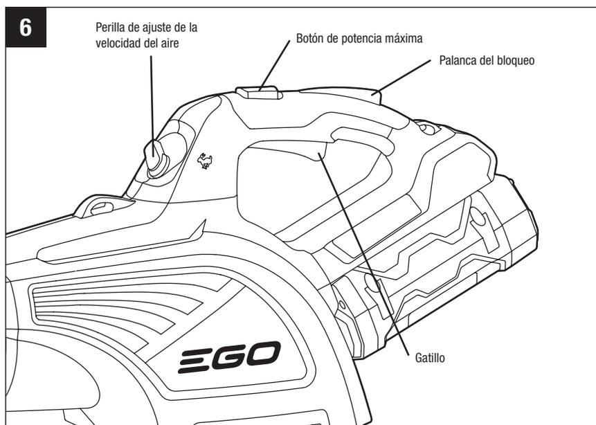
El soplador cuenta con una regulación de velocidad continua para controlar la velocidad del aire.
